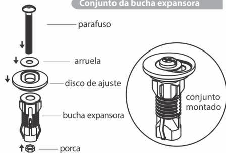
① -Monte cada fixador com o conjunto de bucha expansora (1) no fixador (2), e a baseta anti-deslizante (3) por baixo.
