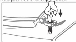
③ -Coloque o assento na bacia e aperte o parafuso, sem dar o aperto final.
