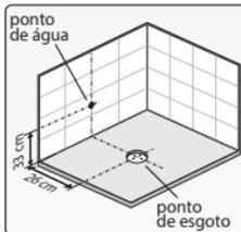
Trace no piso (centro do tubo de esgoto), linhas de centro perpendiculares entre si e paralelas em relação as paredes do banheiro (Fig. a). Em seguida trace uma linha paralela com distância de 6 cm em relação a linha de centro do tubo de esgoto.
