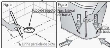
Coloque a bacia na posição de instalação, alinhando o furo lateral da bacia com o traço do piso. Alinhe também o centro da bacia (frontal) com o traço do piso (Fig. b). Trace no piso o contorno externo da base da bacia. Retire a bacia. Vire a bacia, posicione os suportes L (7) alinhando o centro do furo lateral da bacia com o centro do furo do suporte L (7). Com uma trena ou metro meça a distância A (Fig. c). Trace no piso a distância A marcando o local para furação (Fig. d).
