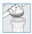
5-Observe se o anel o'ring utilizado para a vedação do filtro está devidamente alojado no interior da tampa.
